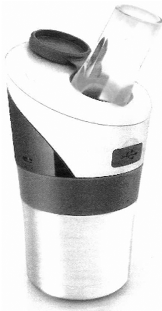
Figura 2 – Fotografia do aparelho X-halo® com saída frontal USB, versão de última geração. A parte de baixo é desrosqueada para limpeza, após cada medida. O bocal intercambiável se ilumina de verde quando está pronto para o uso.
